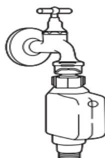
Ống cấp nước an toàn
