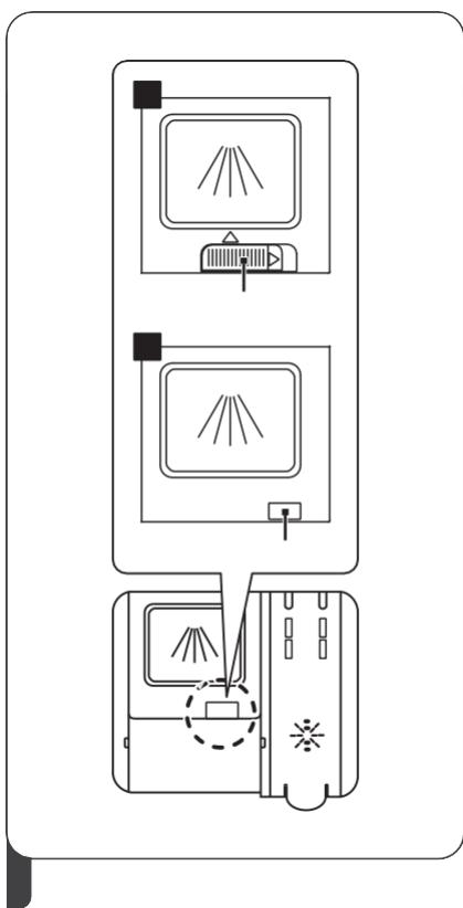
1. Nhấn chốt để mở hộp đựng chất rửa
