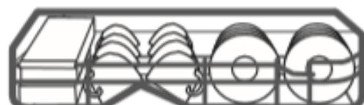
**Giàn dưới** để những vật dụng lớn, khó làm sạch: xoong, chảo, vung, các bát đĩa size to. Nên để đĩa lớn, vung xoong ở bên cạnh để tránh làm chấn tay quay trên. Đường kính tối đa của đồ dùng phía trước hộp đựng chất rửa là 19cm để k làm cản trở việc mở hộp chất rửa.
