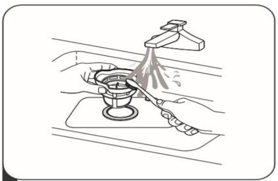
3. Làm sạch bộ lọc bằng cách xả dưới vòi nước và dùng bàn chải mềm để làm sạch kỹ hơn
