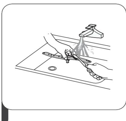
Rửa tay phun bằng xà phòng và nước ấm và dùng bàn chải mềm để làm sạch các lỗ phun nước. Lắp lại chúng sau khi rửa kỹ.
