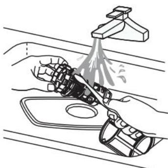
3. Làm sạch bộ lọc bằng cách xả dưới vòi nước và dùng bàn chải mềm để làm sạch kỹ hơn
