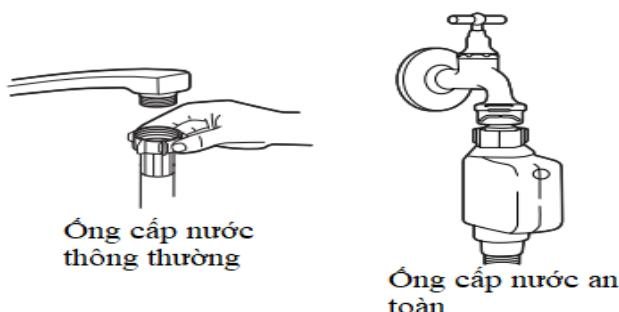
Ống cấp nước an toàn đảm bảo rằng nước sẽ không chảy ra trong trường hợp ống bị gãy, thủng hay gấp nếp.
