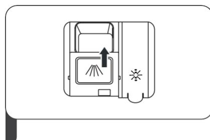
3. Đóng nắp bằng cách trượt lên trước và nhấn xuống
