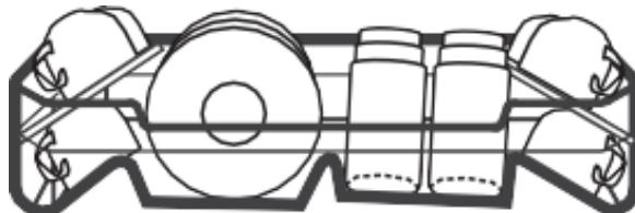
**Giàn dưới** để những vật dụng lớn, khó làm sạch: xoong, chảo, vung, các bát đĩa size to. Nên để đĩa lớn, vung xoong ở bên cạnh để tránh làm chấn tay quay trên. Đường kính tối đa của đồ dùng phía trước hộp đựng chất rửa là 19cm để k làm cản trở việc mở hộp chất rửa.
