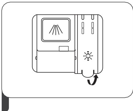
1. Mở nắp hộp đựng chất trợ xả theo chiều mũi tên và nhấc ra
