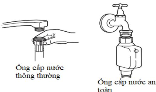
Ống cấp nước an toàn đảm bảo rằng nước sẽ không chảy ra trong trường hợp ống bị gãy, thủng hay gấp nếp.
