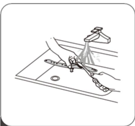
3 Rửa cánh tay phun bằng xà phòng và nước ấm. Dùng bàn chải mềm để làm sạch các lỗ phun nước. Lắp lại sau khi rửa kỹ
